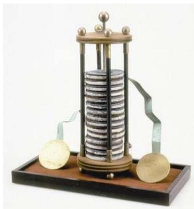
*Pila di Volta*
